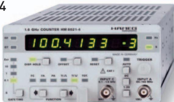
Campo de medición de 0 Hz hasta 1,6 GHz
